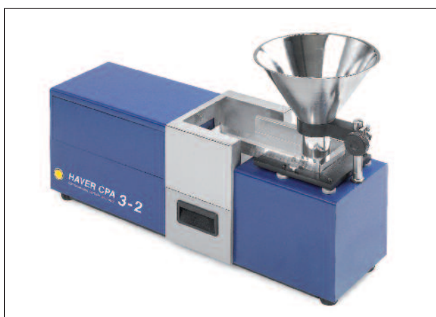
HAVER CPA 3-2, Partikelmessgerät für Korngrößen- und Kornformanalysen in zwei Messbereichen
