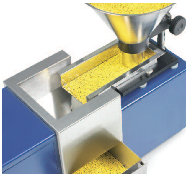
HAVER CPA 3-2 bei der Vermessung von Kunststoffgranulat
