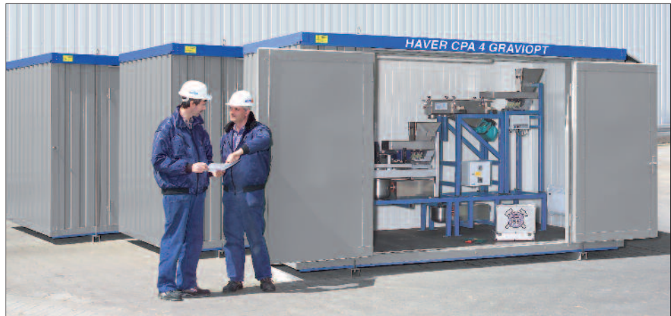
HAVER CPA CONTAINER mit Photoptischen Partikelanalysegeräten als "Plug and Play"-Lösung
